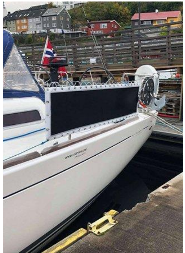
Panelene er ikke avhengig av direkte sollys og kan monteres både på horisontale flater og som lettrekk som vist på bildet.
