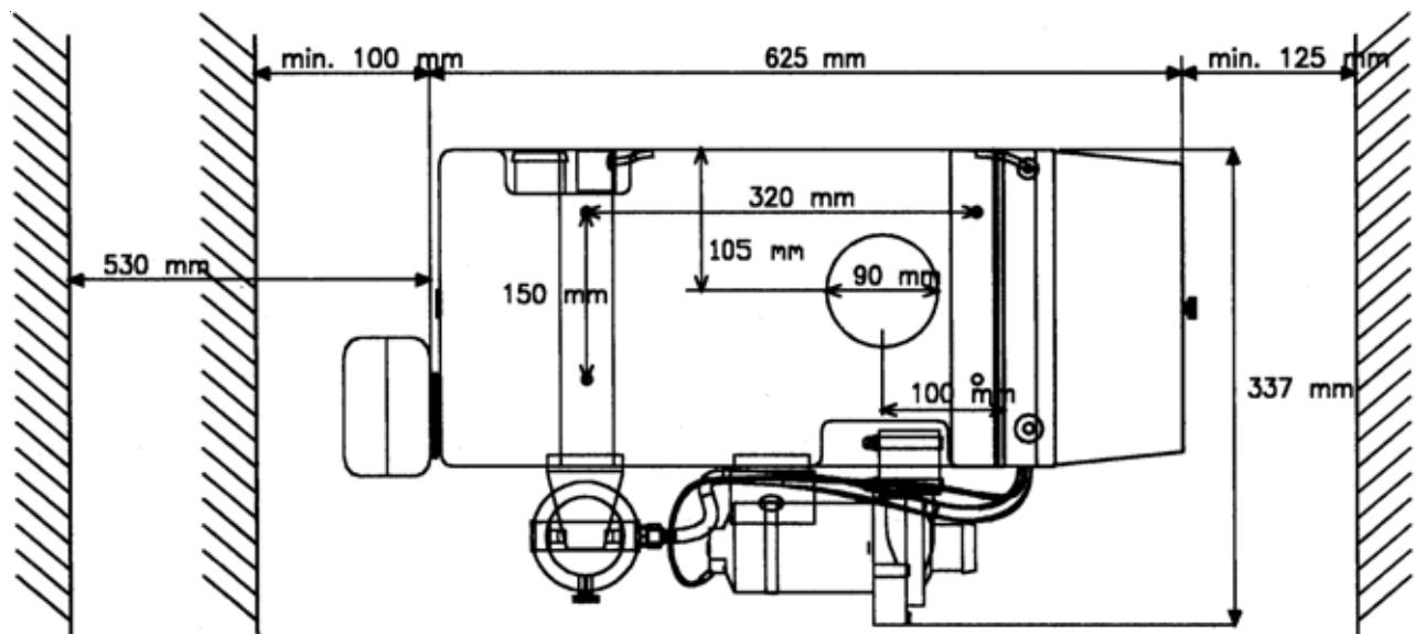
Ved varmerens brennerende skal det være tilstrekkelig plass til å avmontere varmerens brennerdel og brannrør. Minimumsavstand som vist på skissen. Det anbefales å montere varmeren på svingningsdempere. Hvis dette gjøres skal det over alt være fleksible slangeforbindelser til varmeren.
