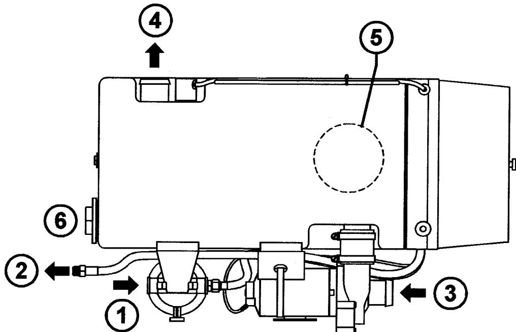
**Pos 1:** Inngang for dieseltilførsel(til varmerens oljepumpe fra dieseltank):
